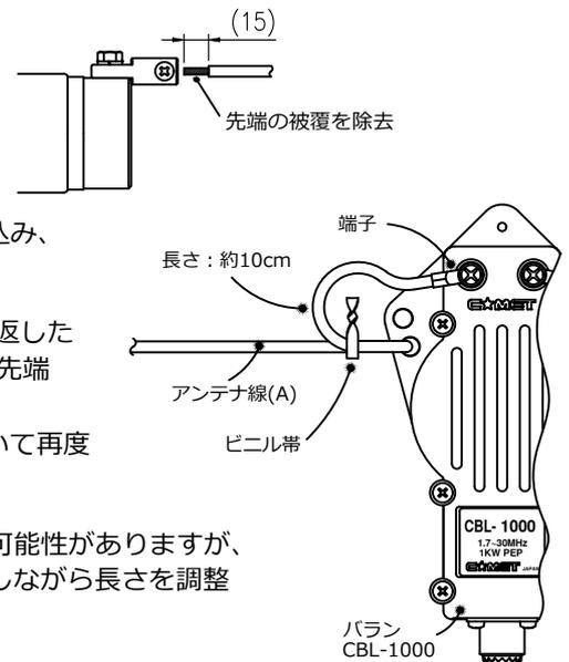
注. 碍子までの全長が調整用ヒゲ分短くなり、前ページの寸法に満たなくなる可能性があります。調整マージン確保のため若干長めに設定してありますので、共振周波数を確認しながら長さを調整してください。
