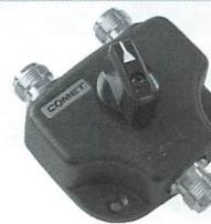
**特長** CSW-201Gは高周波信号を50Ωのライン上で切り換える手動式の2接点同軸切替器です。金メッキした接栓を使用し、接触抵抗の低減化を図りました。高周波信号用として高周波特性を重視して設計された同軸切替器です。筐体は同軸構造を形成し、次の特性を有します。
