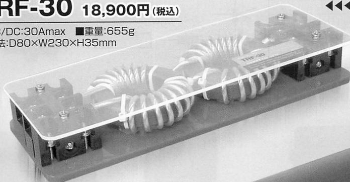
送信機のACラインと大地の間にアースループが発生しています。このループ上に接続されているラインからコモンモードのスプリアス(高調波)を放射します。このループを遮断する事によりスプリアスを軽減する事ができます。
