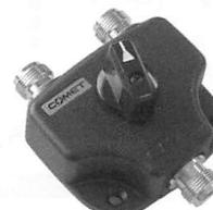
**特長** CSW-201Gは高周波信号を50Ωのライン上で切り換える手動式の2接点同軸切替器です。金メッキした接栓を使用し、接触抵抗の低減化を図りました。高周波信号用として高周波特性を重視して設計された同軸切替器です。筐体は同軸構造を形成し、次の特性を有します。
