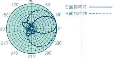
レピータ局の混信、特にビル、高台に住む方は、従来のGPアンテナでの交信で混信に悩まされたことがあると思います。このCA-430GXは、必要のないレピーターを動作させずに、方向をビームアンテナ並に選ぶことができます。また、サイド、バックの電波をおさえることにより、フロントゲインを上げ、フォックスハンティングでも抜群の力を発揮します。
