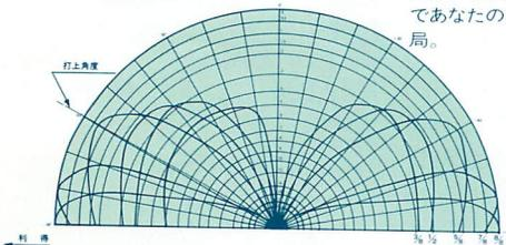
コメットは、ビームパターンを重視しますから、飛びは抜群の性能を保障します。近距離、遠距離、ビル街などタイプに応じて自由に使い分けてください。都市部では、 $\frac{1}{2}\lambda$ 、 $\frac{3}{8}\lambda$ など、遠距離通信には $\frac{5}{8}\lambda$ 、 $\frac{7}{8}\lambda$ 、 $\frac{9}{8}\lambda$ 、 $\frac{11}{8}\lambda$ などが適しています。
