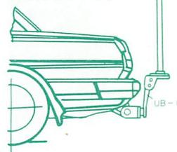
牽引フック取付金具への取付例 (UB-1)
