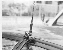
RS-36をドアフレームに取り付ける
