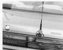
RS-21をトランク下側に取り付ける
