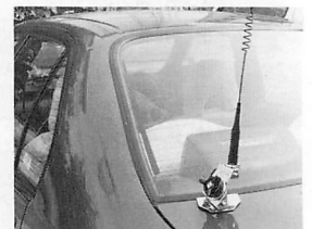
RS-21を変角調整してトランク上側に取り付ける
