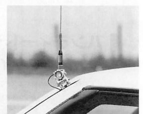
RS-30をハッチバック側面に取り付ける
