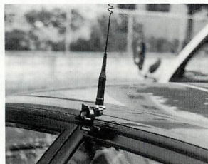
RS-36をドアフレームに取り付ける
