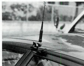
RS-36をドアフレームに取り付ける
