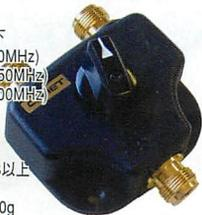
**特長** CSW-201Gは高周波信号を50Ωのライン上で切り換える手動式の2接点同軸切替器です。金メッキした接栓を使用し、接触抵抗の低減化を図りました。高周波信号用として高周波特性を重視して設計された同軸切替器です。筐体は同軸構造を形成し、次の特性を有します。●周波数範囲が広い ●通過損失(挿入損失)が少ない ●SWRが低い
